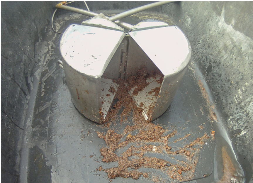
Foto 1.5. Van-Veen tüüpi kopaga võeti proove pehmetest merepõhja setetest.
