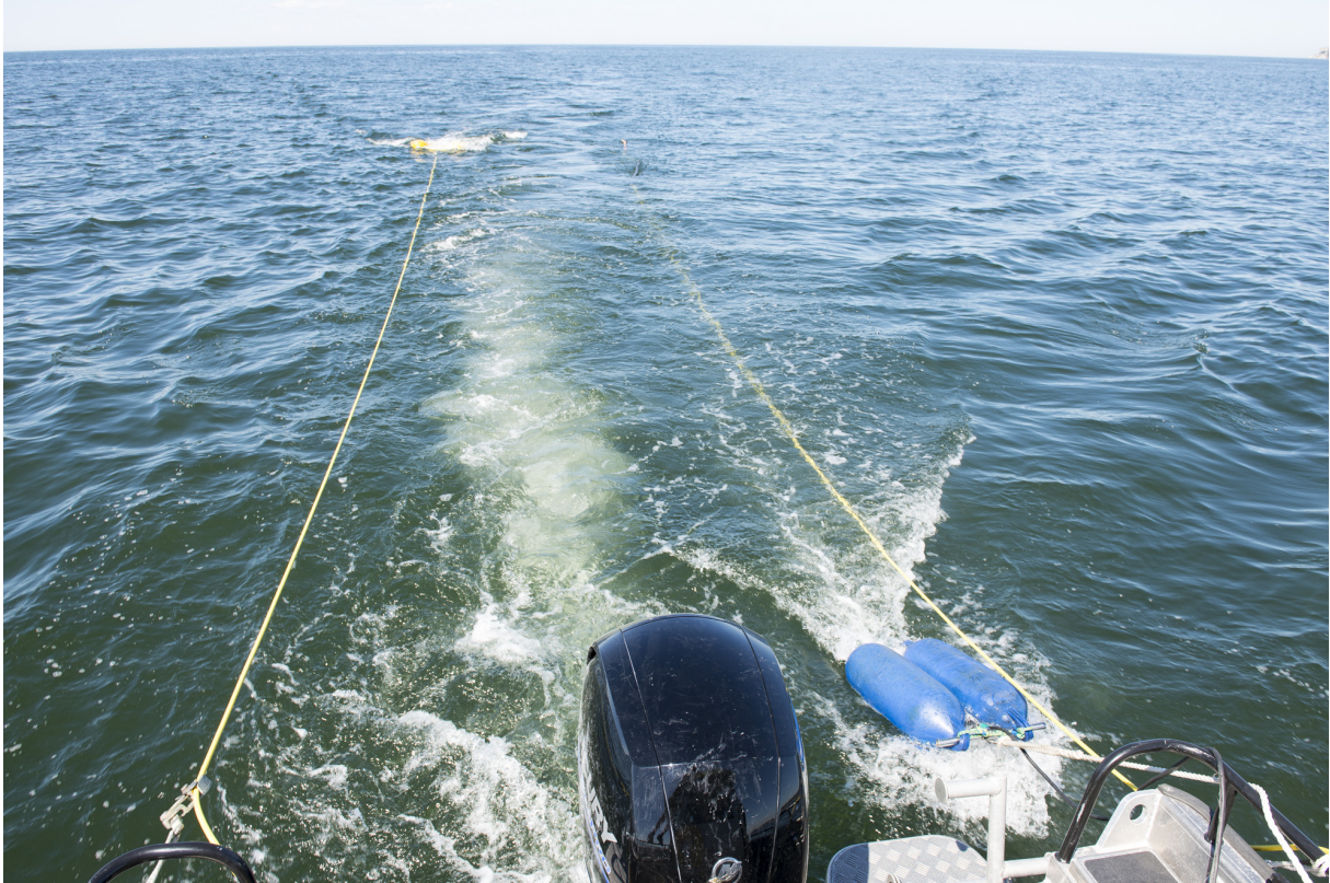
Foto 1.3. Madalsagedusliku põhjaprofilaatori ( Boomer ) lainekiirus ja vastuvõtja (taamal) ning madalsagedusliku kajaloe kiirgur-vastuvõtja (sinine) laeva ahtris.
