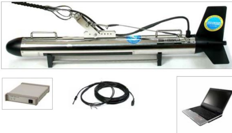
Joonis 1.4. Kahesagedusliku külgvaatesonari süsteem SonarBeam S-150: kiirgur-vastuvõtja, andme- edastusseade, kaabel, arvuti.
