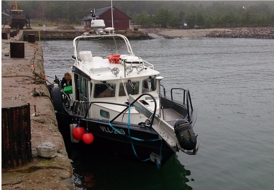
Joonis 2.3.3.1. TÜ Eesti Mereinstituudi uurimislaevale AluDevil 33. Vööris sonari Reson SeaBat 7101-Flow pea transpordiasendis.
