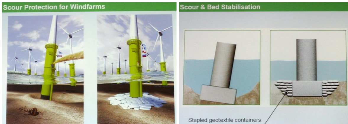
Joonis 144. Lehtrikujulised süvendid, mis on kujunenud tormitegevuse tulemusel merepõhjale rajatud vundamendi postide ümber (Klompmaker & Lenze, 2008)
